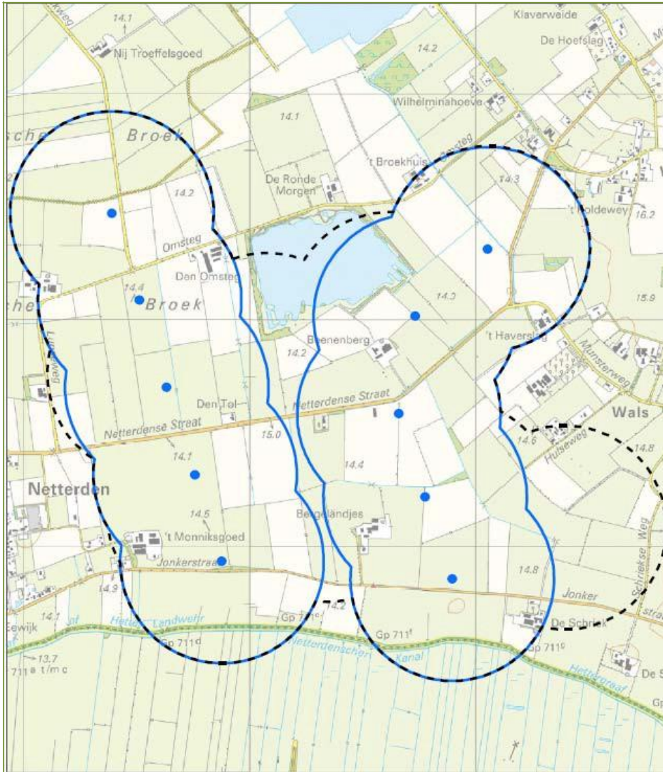
Figuur 2. Opstelling van de huidige voorkeursvariant voor windpark Den Tol in het plangebied 'Den Tol' volgens alternatieven 2 en 3. De blauwe stippen geven de locaties van de windturbines aan; de windturbines worden op ongeveer 350 meter van elkaar geplaatst. De blauwe omlijning geeft de verstoringszone van 450 meter aan die in de Passende beoordeling van Arcadis (2015) is gehanteerd. De meest zuidelijke windturbine aan de Jonkerstraat is inmiddels uit het plan geschrapt in verband met visuele verstoring van weidevogels in het Natura 2000-gebied 'Heter-Millingerbruch'.
