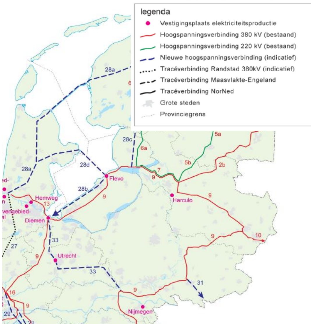
Figuur 1 Uitsnede kaart SEVIII, inclusief een schematische weergave van de verbinding van DW380 (nummer 31).
