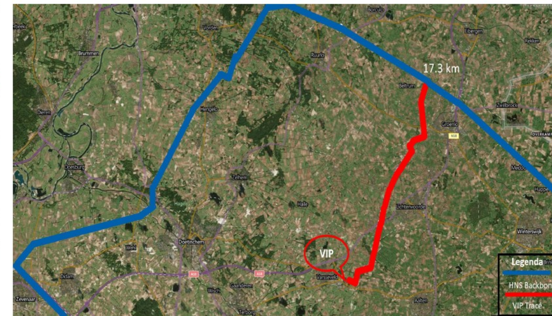
Figuur 2. Potentieel waterstoftracé tussen de VIP en de backbone gebaseerd op de gasinfrastructuur
