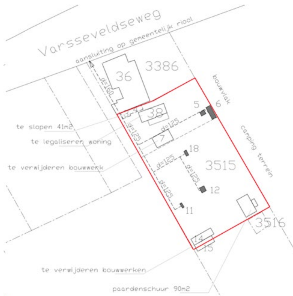
Figuur 6: Bestaande situatie van bouwwerken binnen het huidige bestemmingsvlak 'Recreatie – Verblifsrecreatie' met de functieaanduiding 'specifieke vorm van recreatie - kleinschalig kampeerterrein' (bron: Bouwkundig Bureau J. Mentink)
