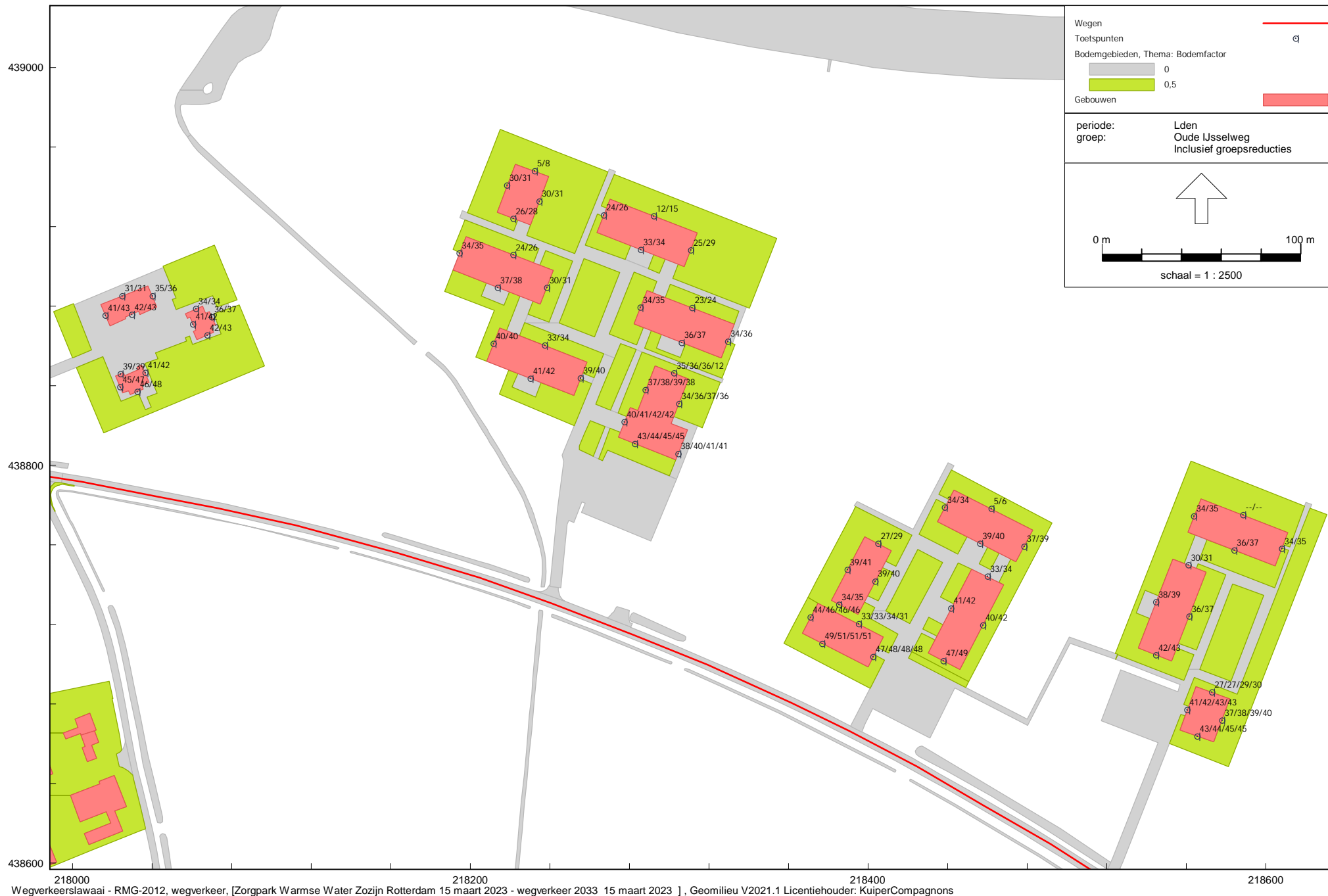
Bijlage 4: Berekeningsresultaten Oude IJsselweg Resultaten inclusief 5 dB reductie ex artikel 110g Wgh
