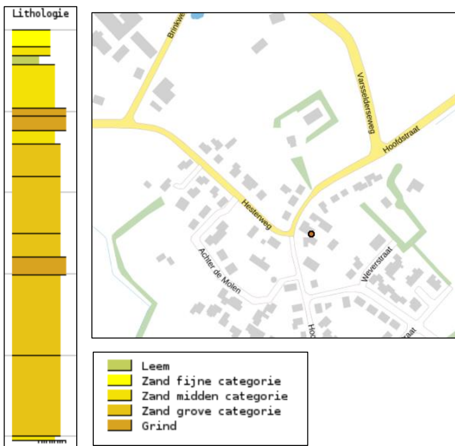
Afbeelding 4: Boorprofiel B41C0011 (bron: TNO)
