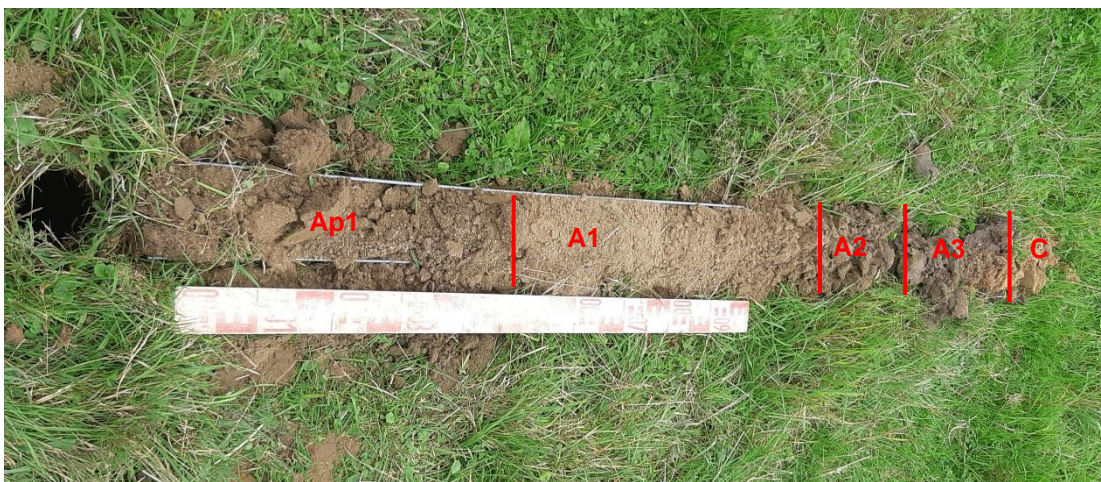
Afbeelding 13: Boring 2 met van links naar rechts de bouwvoor (Ap1), de cultuurlaag (A1), het spoor (A2-A3) en de rivierterras-afzettingen van de Formatie van Kreftenheye (C).
