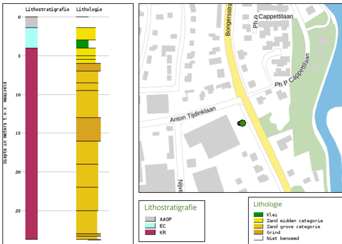
afbeelding 5: Boorprofiel B41C0027 (bron: TNO)
