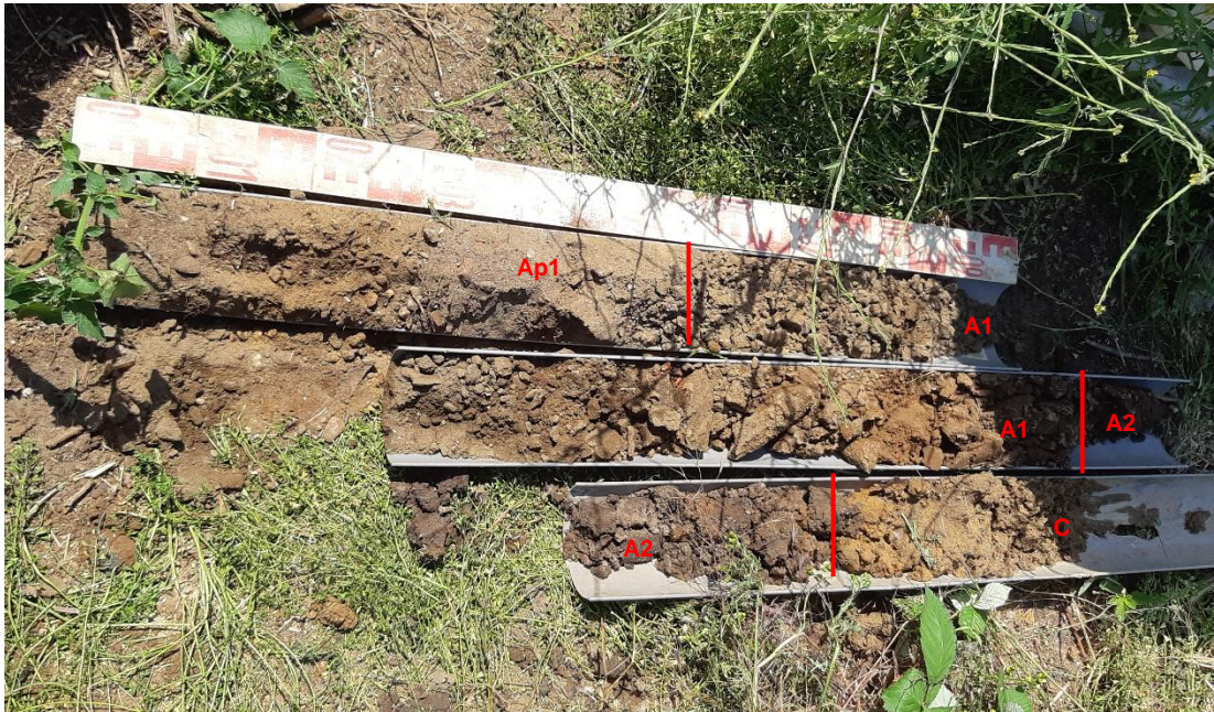
Afbeelding 13: Bodemopbouw van boring 4. Leesrichting van boven naar beneden en van links naar rechts.
