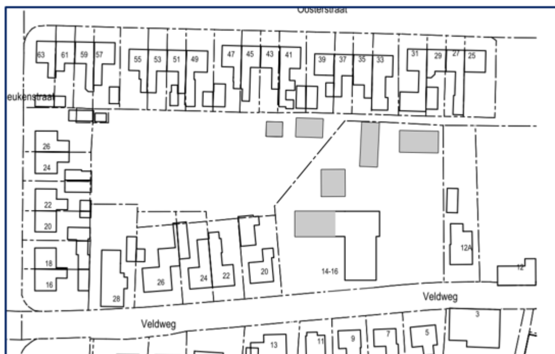
Figuur 2.4: de te slopen bouwwerken binnen het plangebied (bron: PLAN ARCHITECTEN)
